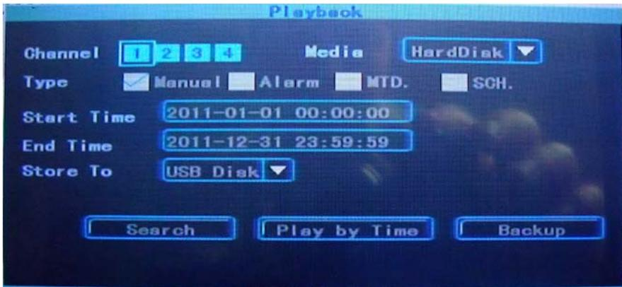
E' possibile scegliere i canali da rivedere e il tipo di registrazione. Negli spazi START TIME e END TIME impostare il periodo di tempo su cui effettuare la ricerca. Nello spazio MEDIA selezionare SD card.
