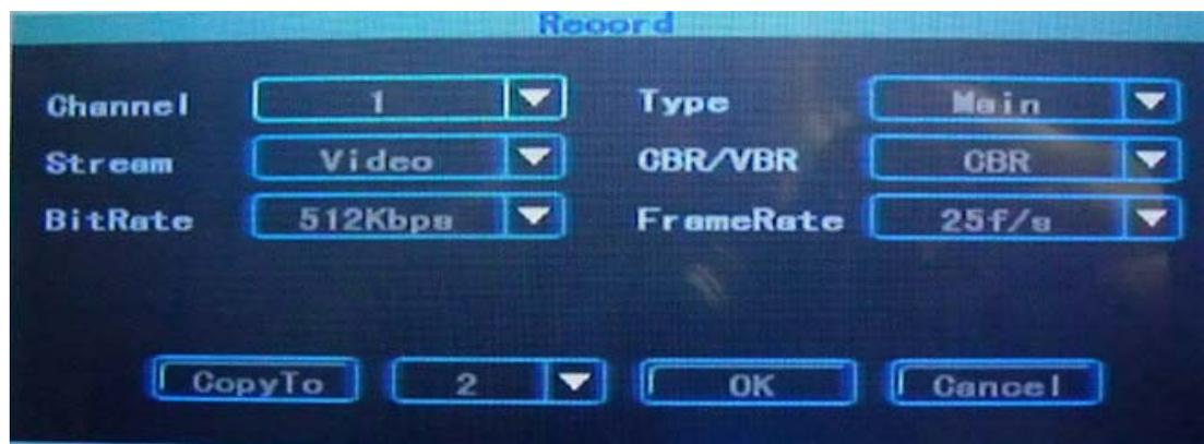
Questa sezione permette di impostare i parametri video dei 4 canali
