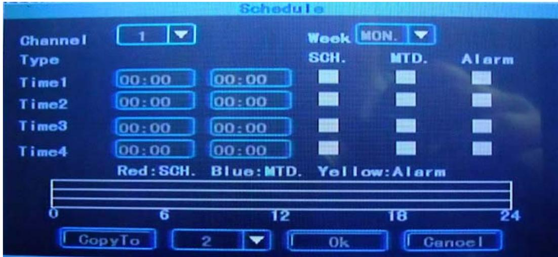
Per ogni canale è possibile stabilire delle registrazioni programmate a seconda della fascia oraria e del giorno della settimana.
